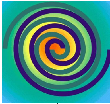
Hình 2.33: Cấu tạo của máy nén roto xoắn ốc
